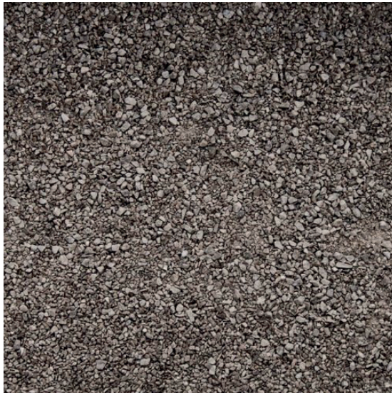
mechanicky zpevněné kamenivo (MZK)
