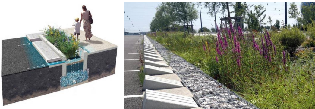
Obrázek 2-19 Schéma osázeného průlehu s kolmými stěnami (vlevo)
