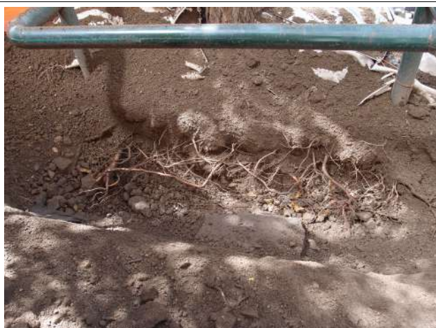
Obr. 7 Patrná změna intenzity prokořenění na hranici rozhraní zhutněné a nezhuťněné půdy
