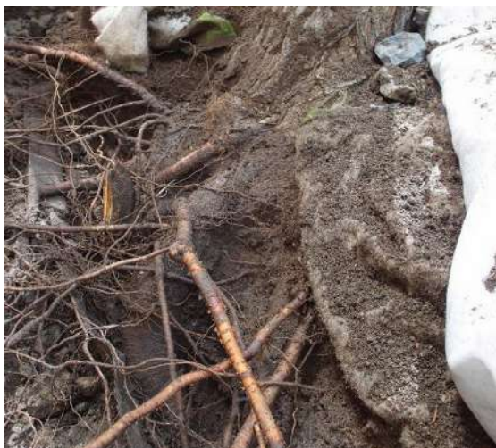
Obr. 10 Kořenová bariéra cca 0,25 m od osy kmene
