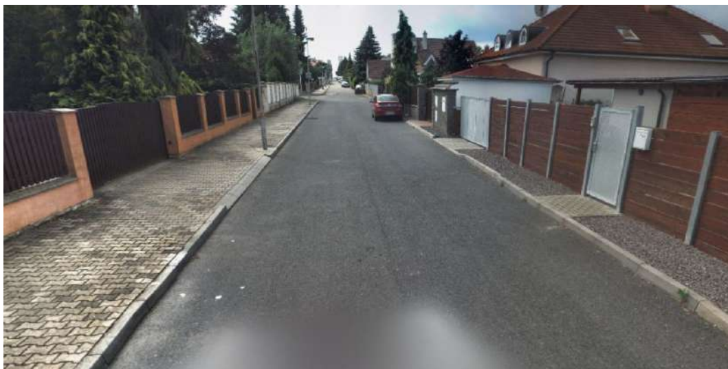
Obr. 40 Příklad nevhodně provedené obytné zóny s předdimenzovanými dopravními plochami, bez možnosti výsadby
